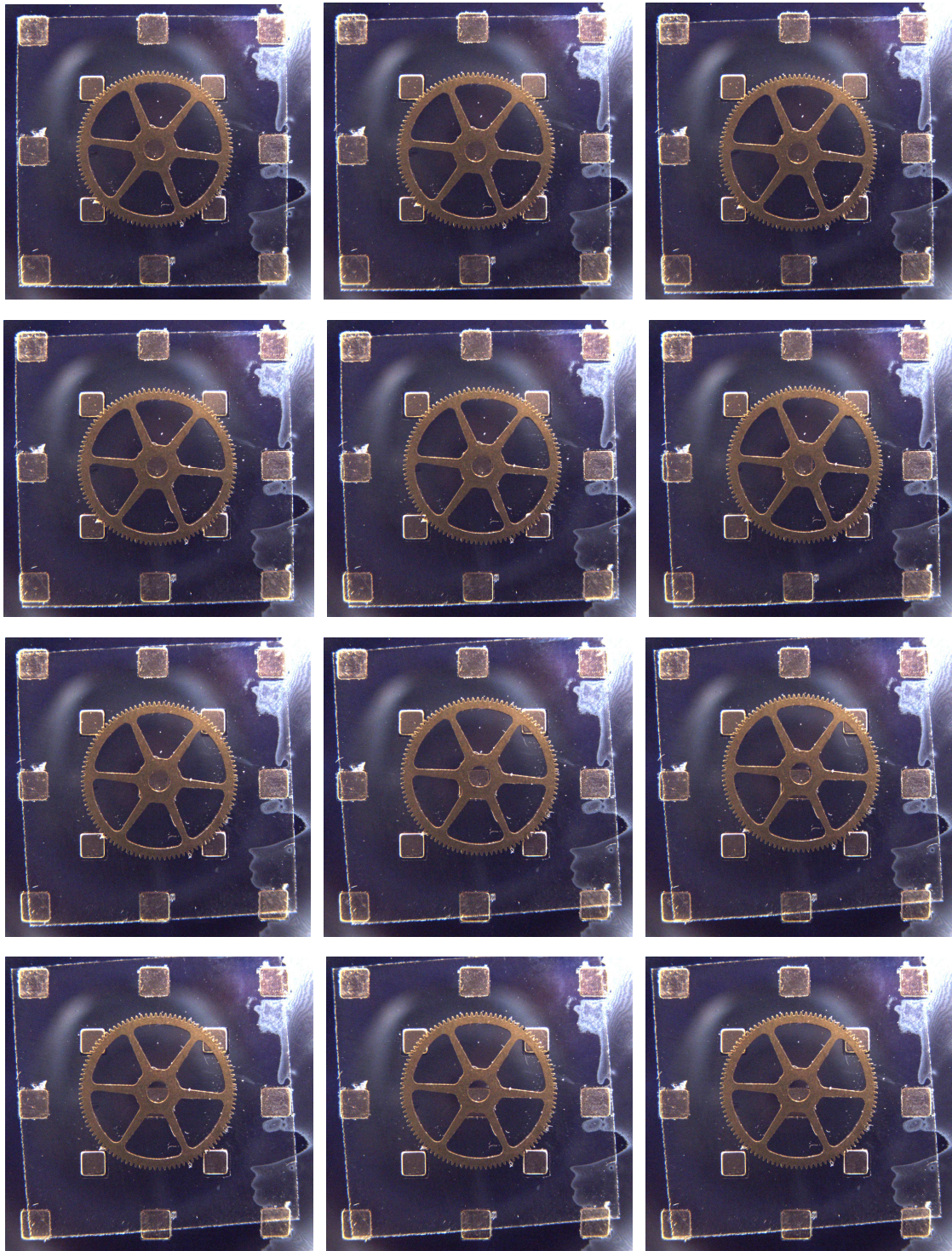
Figure 66. convoyage d'une pièce d'horlogerie sur le réseau 2x2 1 er ligne : translation en X (0 pas, 3 pas, 5 pas) 2 e ligne : translation en Y (0 pas, 3 pas, 5 pas) 3 e ligne : translation en diagonale (0 pas, 3 pas, 5 pas) 4 e ligne : rotation antihoraire (0 pas, 3 pas, 5 pas)
