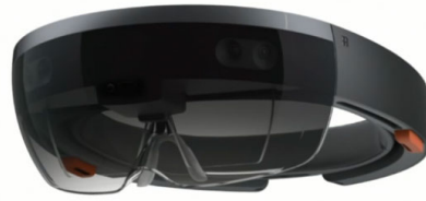
(b) Casque de réalité augmentée Microsoft HoloLens qui scanne son environnement et permet une localisation de l'utilisateur.
