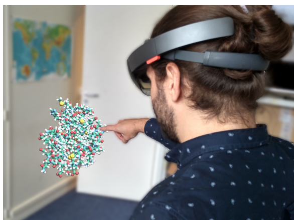
FIGURE 4.27 – Utilisation d’un HoloLens pour la visualisation de données moléculaires grâce aux représentations adaptées à la RA de UnityMol.
