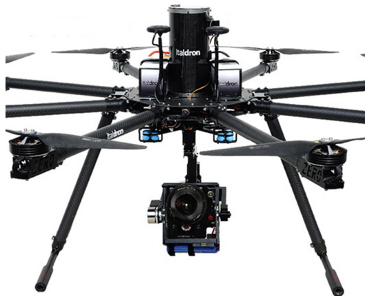
(d) Caméra 3D montée sur un drone pour scanner des bâtiments, des monuments de grande taille ou même des reliefs. Source : [Scab]
