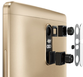
(d) Capteur de profondeur intégré dans un smartphone du projet Tango de Google.
