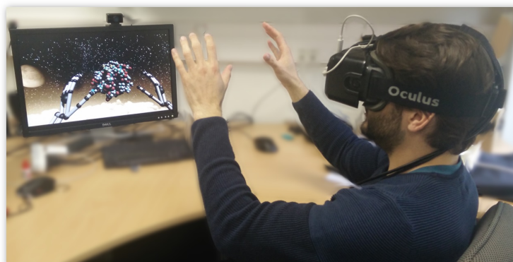
FIGURE 2.20 – UnityMol dans un contexte de RV avec un dispositif d'interaction adapté, le Leap Motion pour retranscrire les mains de l'utilisateur dans le monde virtuel.
