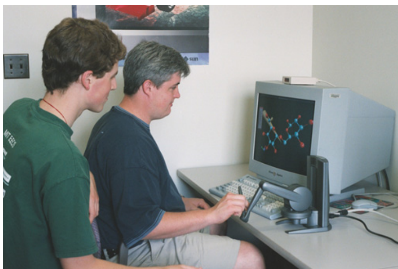
FIGURE 1.12 – Travaux de J. Stone sur la dynamique moléculaire interactive grâce au couplage de VMD avec NAMD et un bras haptique.
