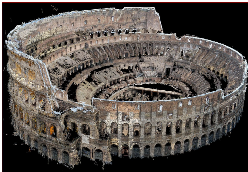
FIGURE 3.7 – Reconstruction du Colisée à Rome grâce à de nombreuses photos de touristes avec la méthode de SFM.
