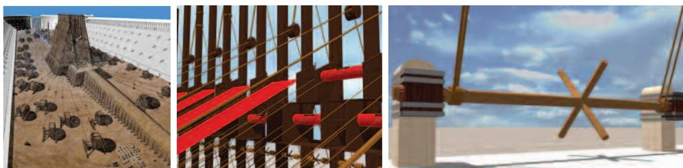
FIGURE 2.5 – Gauche : Rampe, portique et machines de levage de l'obélisque du Circus Maximus (aquarelle et modélisation) / Milieu : Hypothèse de déroulement de toiles en quinconce au-dessus du Colisée / Droite : Reconstitution d'un système de treuil manoeuvré par les marins d'une flotte impériale (Lecocq, 2003)
