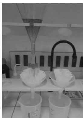
Fig 24. Etape 3 : la séparation par liqueur dense (E 10)
