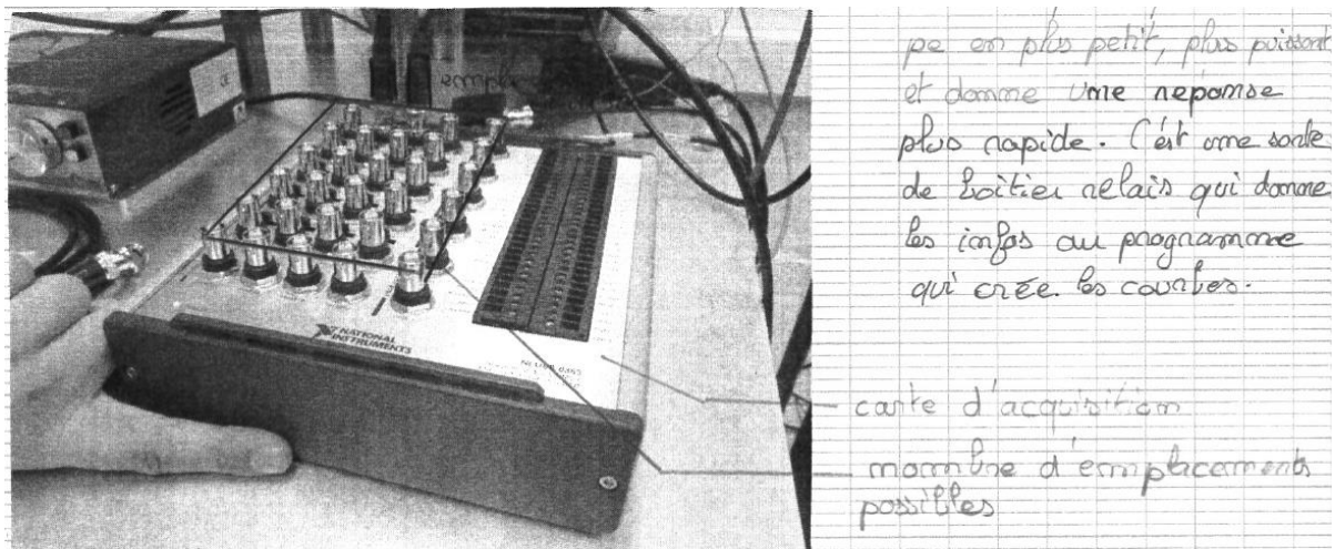
Fig 15. Photographie légendée de la carte d'acquisition (G 6)
