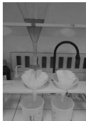
Fig 24. Etape 3 : la séparation par liqueur dense (E 10)
