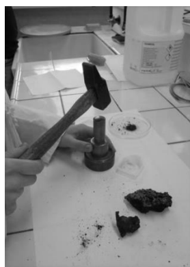
Fig 22. Etape 1 : le broyage (E 9)
