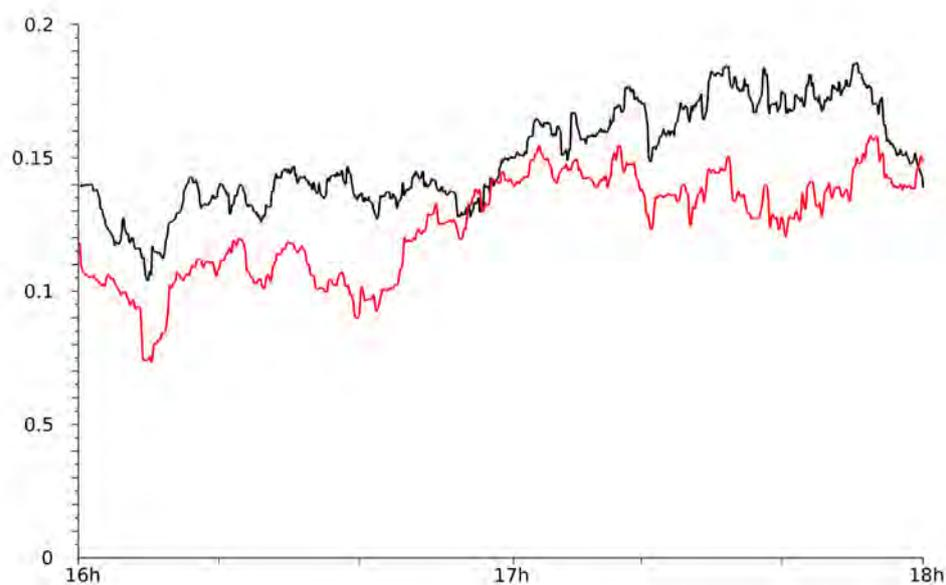
FIGURE 4.20 – En rouge l'intensité turbulente estimée, en noir l'intensité turbulente calculée, pour un niveau vertical (100m) au cours du temps (2h).
