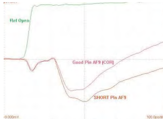
Figure 27 : Exemple d'analyse TDR [29].
