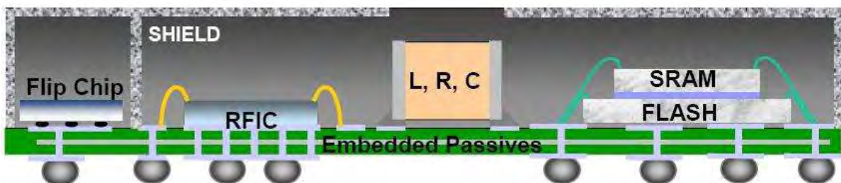
Figure 5 : Exemple d'organisation d'un system in package [4].
