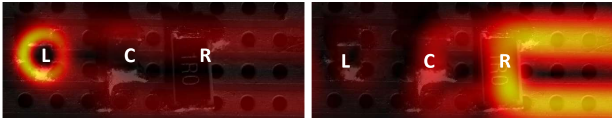
Figure 71 : Superposition de l'image optique et de l'image de courant d'un second circuit RLC parallèle, (a) Image de courant obtenue depuis la voie X dans des conditions standard d'utilisation, (b) Image de courant obtenue pour une référence de phase modifiée.
