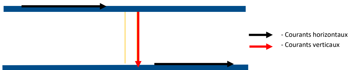
Figure 105 : Schéma de déplacement d'un courant au sein d'un via
