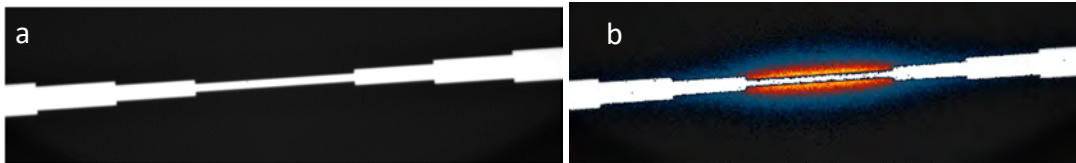
Figure 55 : Observation thermique d'un ouvert résistif. (a) Image topographique, (b) image d'amplitude thermique. Images de phase
