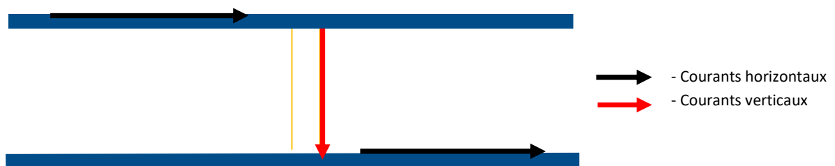
Figure 83 : Schéma de déplacement d'un courant au sein d'un via.
