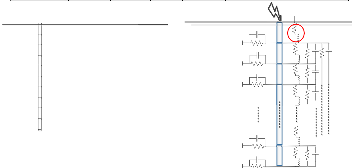
Fig. 125. Modélisation électromagnétique complète du pieu vertical – schéma équivalent à droite
