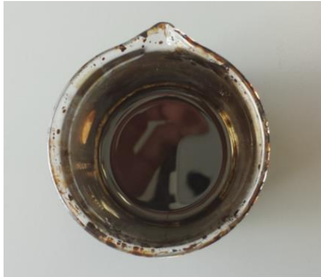
Figure 38. Résidu de la pyrolyse de l'éthylène, formé au cours de l'expérience EP3
