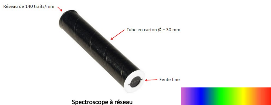
Figure 12. Le spectroscopie utilisé par les élèves et le spectre de la lumière blanche affiché par l'enseignant
