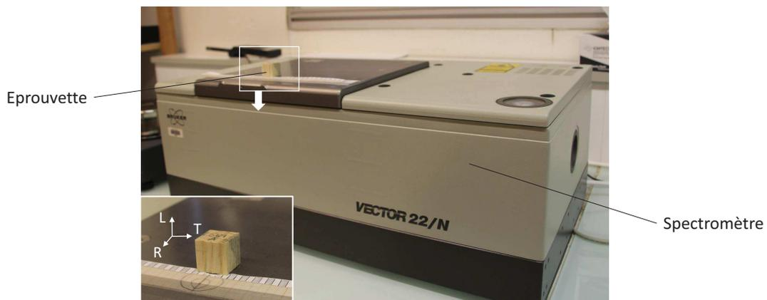
FIGURE 2.27 – Dispositif de mesure de spectrométrie proche infrarouge
