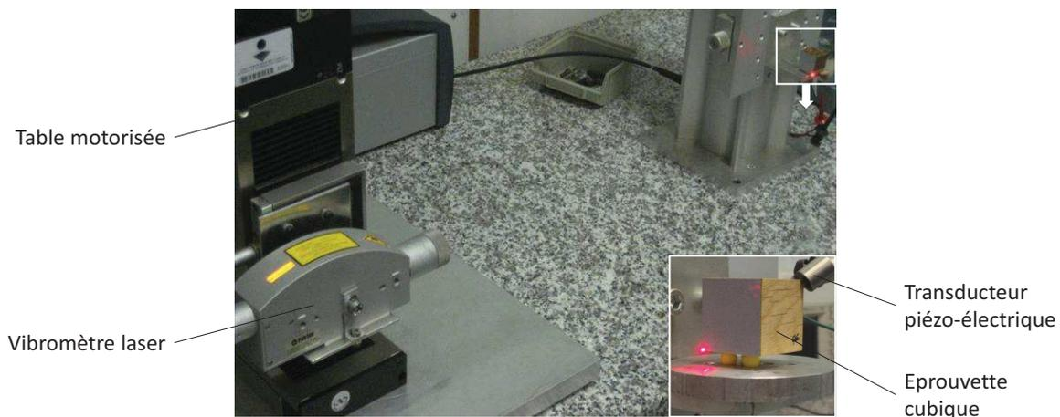
FIGURE 2.11 – Positionnement de l'échantillon de bois, face au laser et contre le transducteur piézo-électrique
