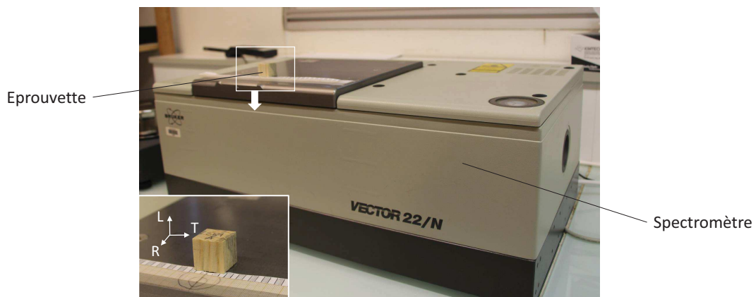
FIGURE 2.27 – Dispositif de mesure de spectrométrie proche infrarouge
