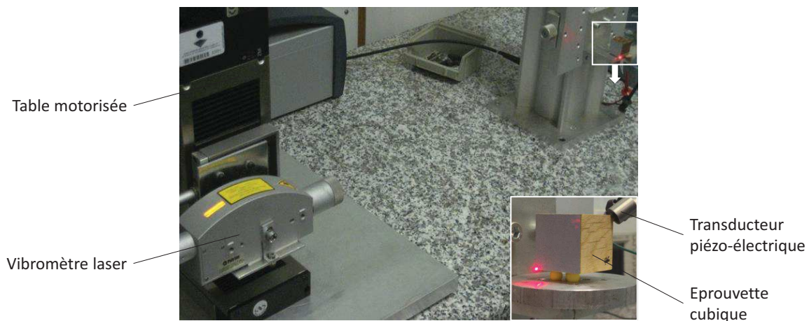
FIGURE 2.11 – Positionnement de l'échantillon de bois, face au laser et contre le transducteur piézo-électrique
