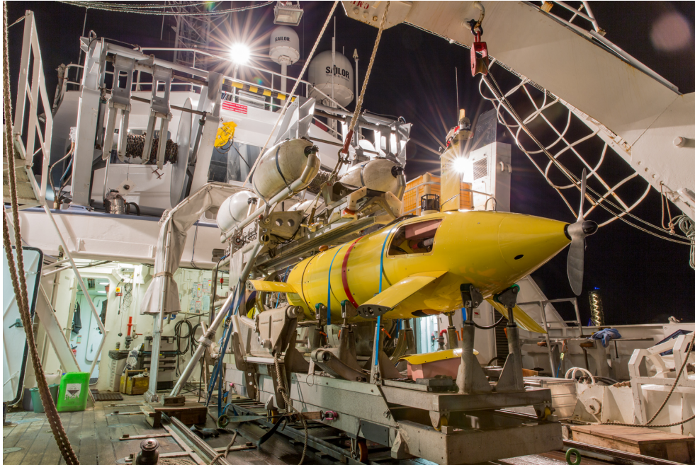
FIGURE 9.4 – Les données accélérométriques et de navigation de l’AUV sont accessibles lorsque ce dernier était amarré sur la plage arrière du navire.
