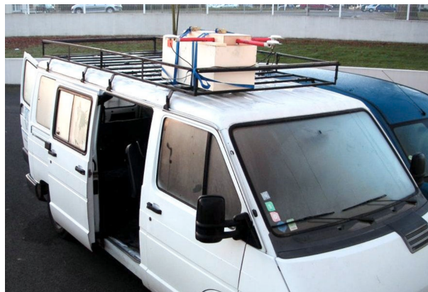
FIGURE 2.5 – Installation du LiMo-g sur la camionnette de l'ESGT lors de la mission d'expérimentation de Domfront en février 2006. (source :[De Saint-Jean 2008])
