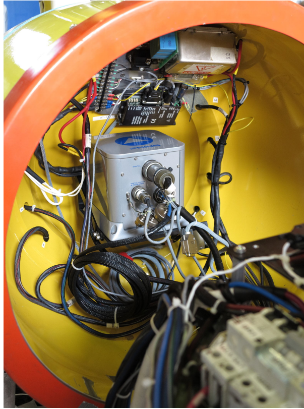
FIGURE 5.2 – La centrale inertielle de l’AUV est développée par la société française iXBlue sous le nom de PHINS .
