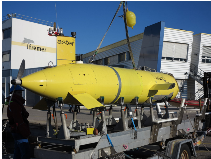
FIGURE 2.10 – Le véhicule porteur choisi pour expérimenter le capteur accélérométrique est le véhicule autonome sous-marin (AUV) Aster x de l'IFREMER.
