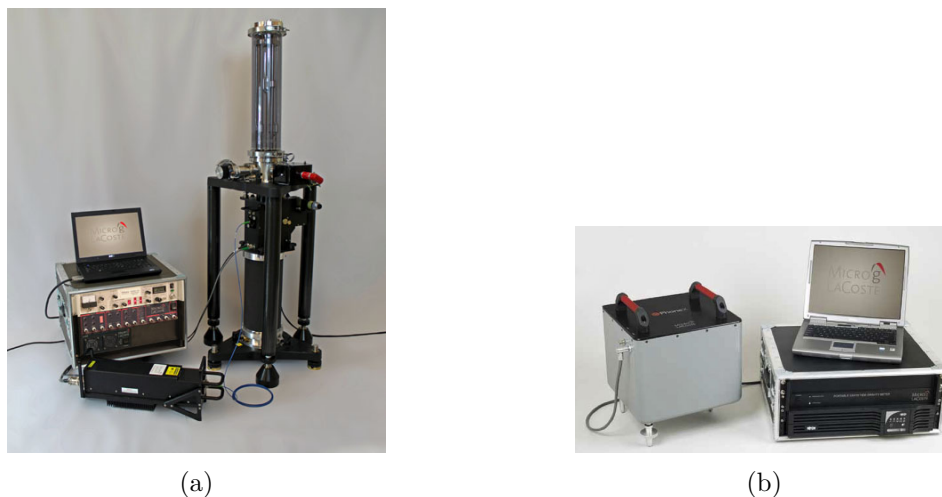
FIGURE 1.4 – Les gravimètres absolu F5-X (a) et relatif gPhoneX (b) de la société américaine Micro-g LaCoste .
