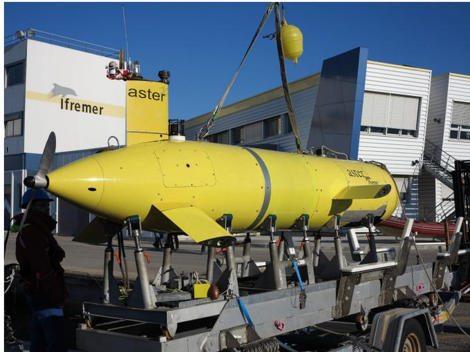
FIGURE 2.10 – Le véhicule porteur choisi pour expérimenter le capteur accélérométrique est le véhicule autonome sous-marin (AUV) *Aster<sup>x</sup>* de l'IFREMER.
