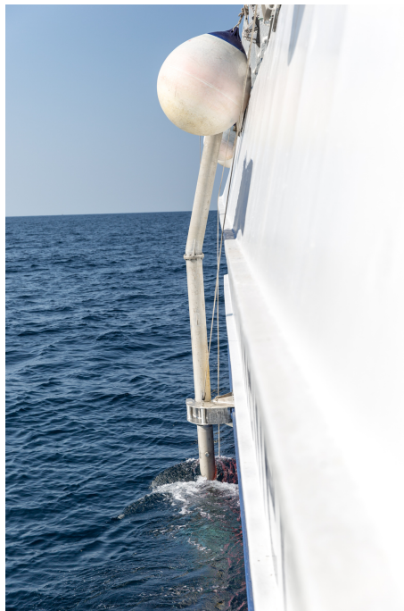
FIGURE 9.3 – Une communication acoustique est utilisée durant la phase d'immersion de l'AUV afin de contrôler sa navigation.
