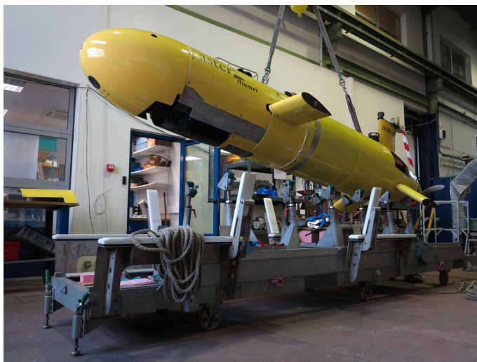
FIGURE 6.1 – La calibration du système GraviMob nécessite de placer l'AUV dans plusieurs inclinaisons statiques pendant quelques secondes.
