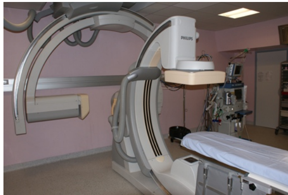
Figure 9 : Imageur double arceau équipé de détecteurs plans numériques ( Allura, Philips, The Netherlands)
