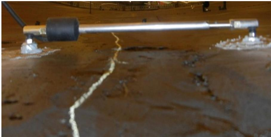
**Figure I.5** - Capteur de déplacement à corde vibrante installé dans la structure à surveiller
