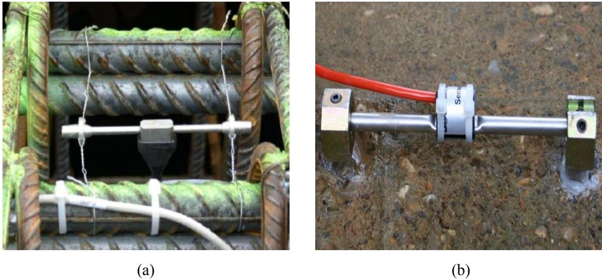
**Figure I.3** - Extensomètre à corde vibrante (a) enfoui et (b) monté en surface
