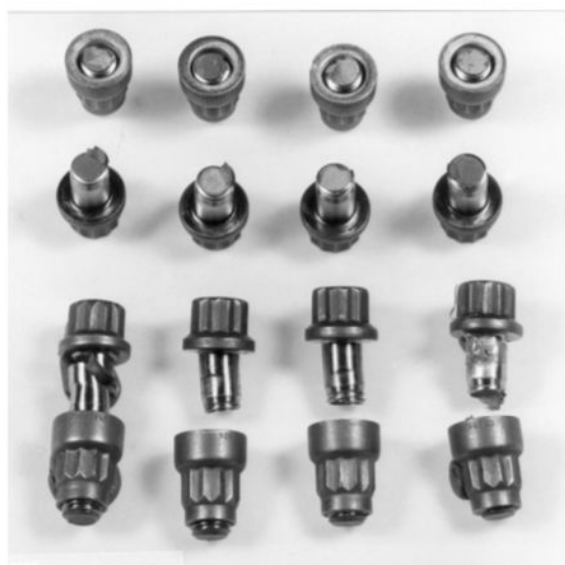
FIGURE 1.8 – Exemple de rupture des vis bihexagonales lors d'essais à rupture
