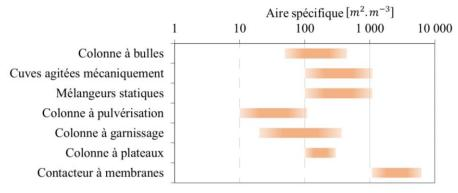
Figure Q.1 – Aire spécifique des équipements de contact gaz-liquide (adapté de [11-13])
