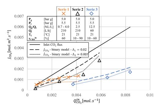
Figure Q.10 – Comparaison des flux expérimentaux de CO<sub>2</sub> absorbés à partir d'un biogaz avec les résultats numériques issus du modèle corrigé *Configuration en boucle ouverte*
