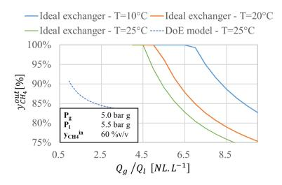
Figure Q.4 – Influence du ratio  $Q_g/Q_l$  sur la qualité du biométhane : comparaison du modèle quadratique issu du plan d'expérience avec les performances d'un échange idéal *Le modèle du plan d'expérience est appliqué pour Q<sub>g</sub>* = 205 *NL*.  $h^{-1}$
