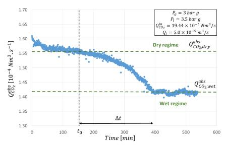
Figure Q.5 – Evolution du débit de CO<sub>2</sub> absorbé en fonction du temps Configuration en boucle ouverte
