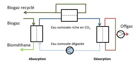
Figure Q.6 - Schéma simplifié de la configuration en boucle fermée avec recyclage de méthane 1:1:1
