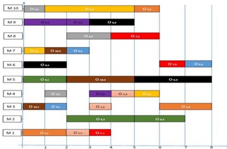
FIGURE 2.11: Le diagramme de Gantt de l'instance 2 (10 jobs * 10 machines)
