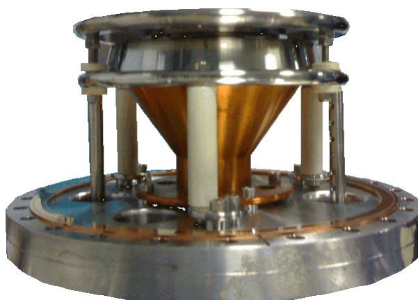
Figure 3.14 : Photographie du détecteur composé de trois galettes de microcanaux et d'une anode en cuivre.
