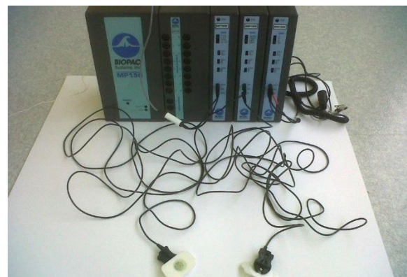
Figure 106 - Système d'acquisition de données BIOPAC MP150, Amplificateur GSR100C et Electrodes EL507»
