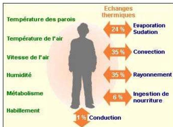
FIGURE 1.1: Six facteurs affectent le confort thermique [<http://labo-energetic.eu>]
