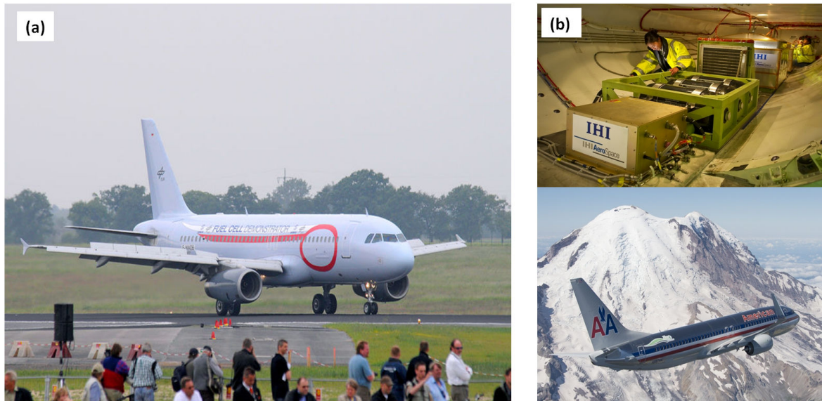
FIGURE 1.11 – (a) : photo de l'Airbus A320 équipé d'un système pile à combustible; (b) : photo du système PEMFC dans la soute du Boeing 737 (haut) et de l'avion en vol (bas)
