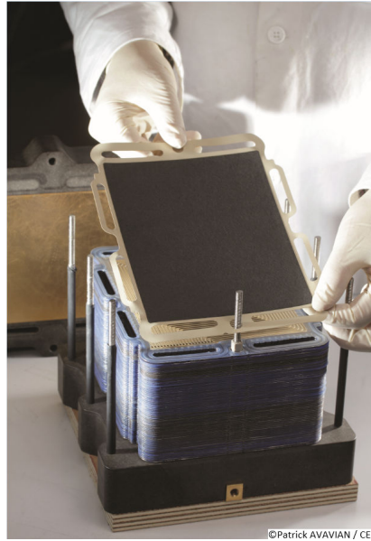
FIGURE 1.8 – Exemple de pile à combustible PEMFC assemblée en stack
