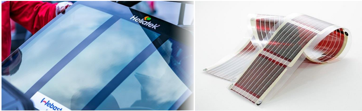
Figure I-1. Photographie de panneaux solaires organiques : gauche : intégrés à un toit de voiture (Source : heliatek.com) ; droites : imprimés sur un substrat polymère.
