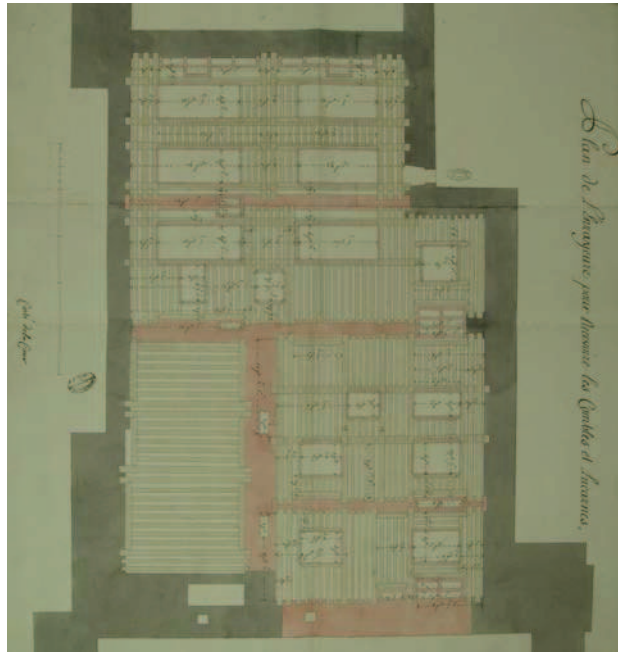
14.10 Plan de l'enrayure pour recevoir les combles et les lucarnes.
