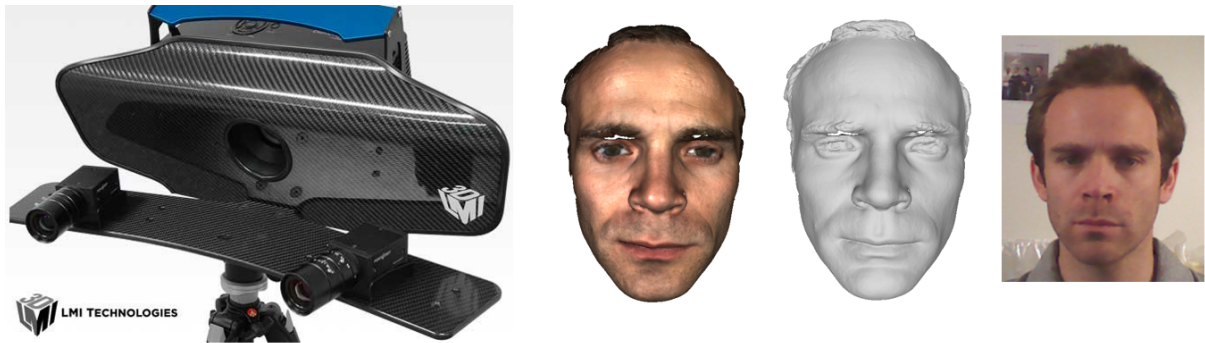
FIGURE II.1.9: Exemple de scan de visage 3D obtenu avec le scanner HDI Advances de LMI technologies.
