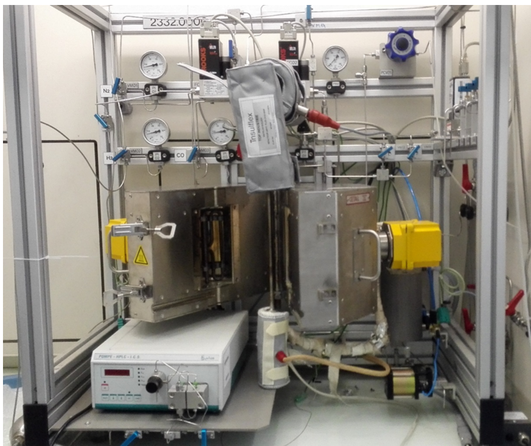
Figure 8 : Photo du réacteur Top Industrie TOP2332 utilisé pour la FTS en lit-fixe
