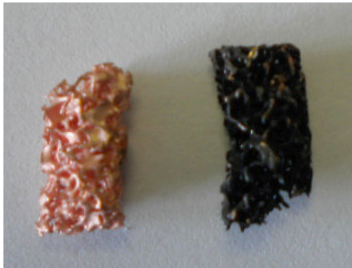
Figure 7 : Photo de la mousse de cuivre avant (à gauche) et après (à droite) croissance des nano-fils de cobalt.
