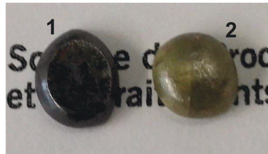
Figure III-34 : Photographies des composites réalisés à 900^\circ\text{C} -5min, à partir de poudre commerciale (1) et de poudre nanocristalline de LNO (2)
