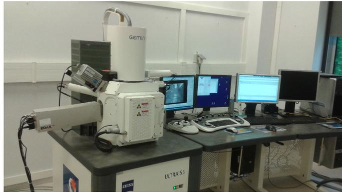
FIGURE 2.8 – Microscope MEB utilisé au LISE
