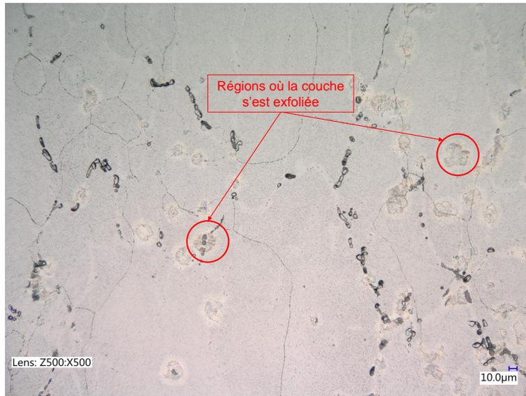
FIGURE 4.11 – Microscopie optique d'un alliage 2024 dégraissé-décapé et converti
