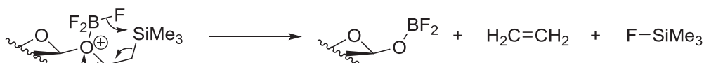
Schéma 51 : Mécanisme de clivage du groupement TMSE par le BF_3 \cdot Et_2O postulé par Jansson et al. 245
