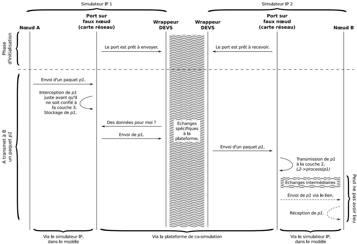
FIGURE 6.5 – Diagramme de séquence correspondant au fonctionnement des ports spatiaux (niveau 3), avec l'exemple d'un paquet IP  $p1$  envoyé de A (port de sortie) à B (port d'entrée), via la plateforme de co-simulation. Correspond à l'exemple de la Figure 6.4.
