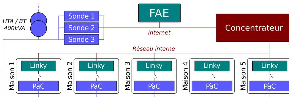
FIGURE 7.25 – Système de réseau électrique intelligent à modéliser.
