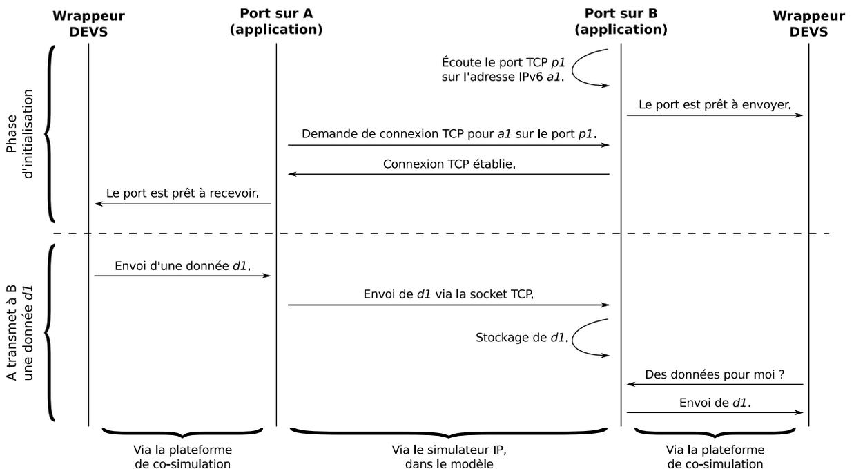
FIGURE 6.2 – Diagramme de séquence correspondant au fonctionnement des ports structurels, avec l'exemple d'une donnée applicative  $d1$  envoyée de A (port de sortie) à B (port d'entrée) en TCP. L'un des deux ports aurait pu être une simple application. Correspond à l'exemple de la Figure 6.1.
