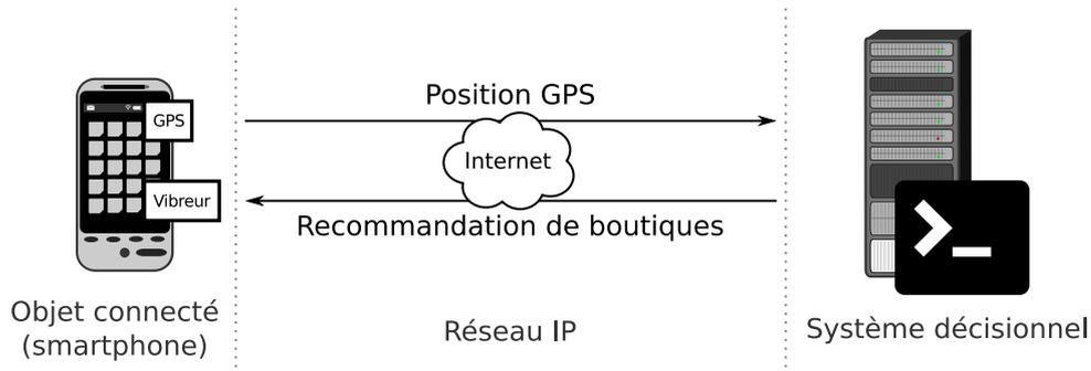
FIGURE 1.1 – Exemple simple d'objet connecté, avec un système de recommandations publicitaires utilisant la localisation GPS (capteur) proposée par un smartphone, pour être capable de vibrer (effecteur) à l'arrivée des nouvelles annonces, avec un réseau IP au centre.
