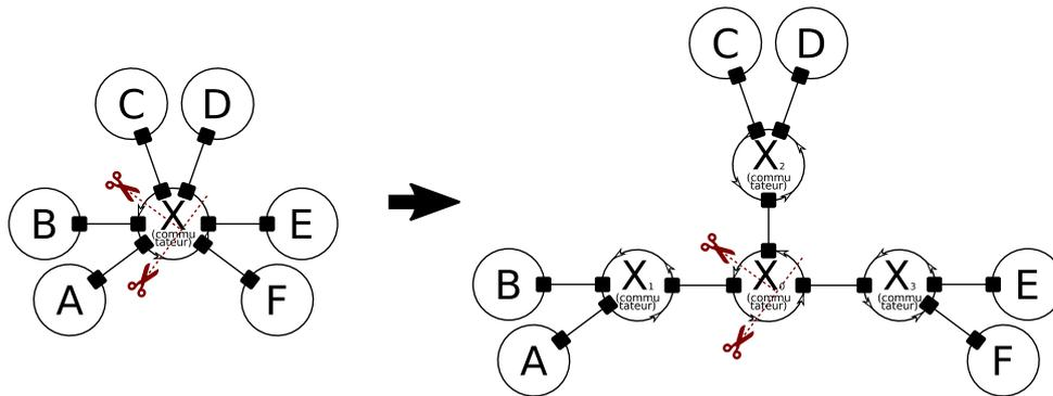
FIGURE 5.18 – Exemple de couplage spatial de type « en  $n$  », pour un nœud de transit de niveau 2 et avec adaptation de la topologie réseau.
