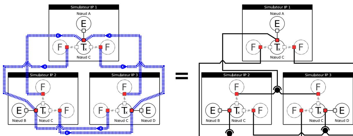
FIGURE 6.9 – Version détaillée des couplages à réaliser, pour l'exemple de la Figure 6.8 (à gauche), avec une version illustrant les artefacts de couplage MECSYCO qui correspondraient (à droite).
