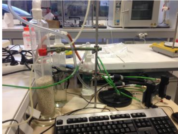
Figure 3.22: Dispositif expérimental permettant de contrôler le taux d'humidité lors de l'expérience
