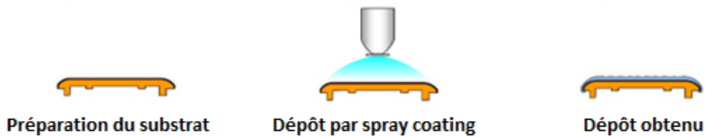
Figure 1.27: Représentation schématique du dépôt par "spray coating" (source YAMAHA)
