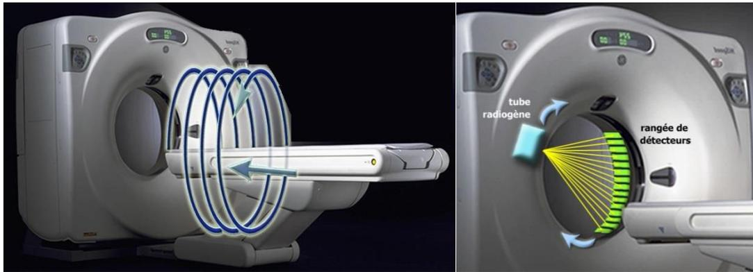
Figure 1.10 Appareil de tomographie assistée par ordinateur X [53]
