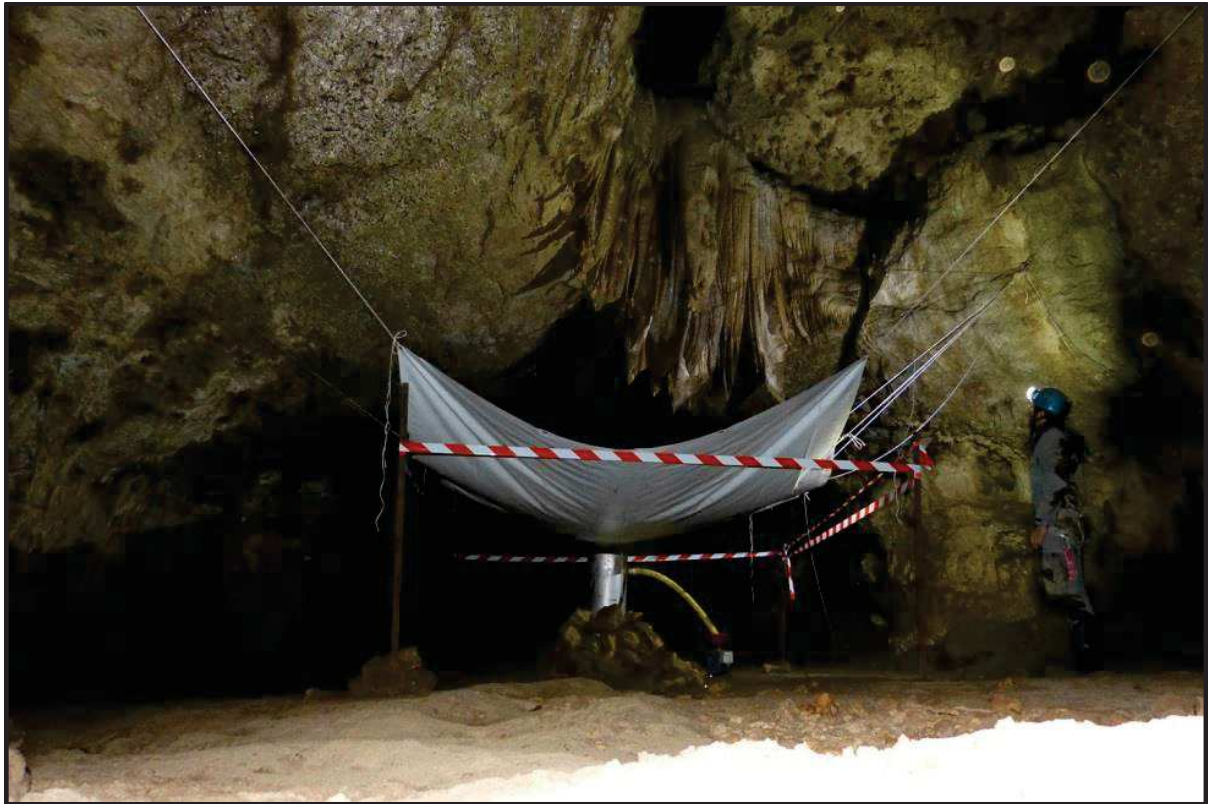
Figure 3.9 : Bâche et pluviomètre à auget au fonds de l'aven de la Beaumelle (-60 m), sur le bassin du Durzon (Larzac), installés dans le cadre de la thèse de Deville (2013). © Jean Chéry.
