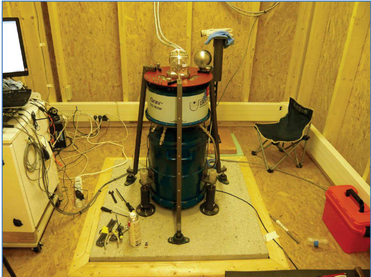
Figure 5.4 : L'iGrav #002 sur son pilier dans la chambre centrale du GEK. © N. Le Moigne.
