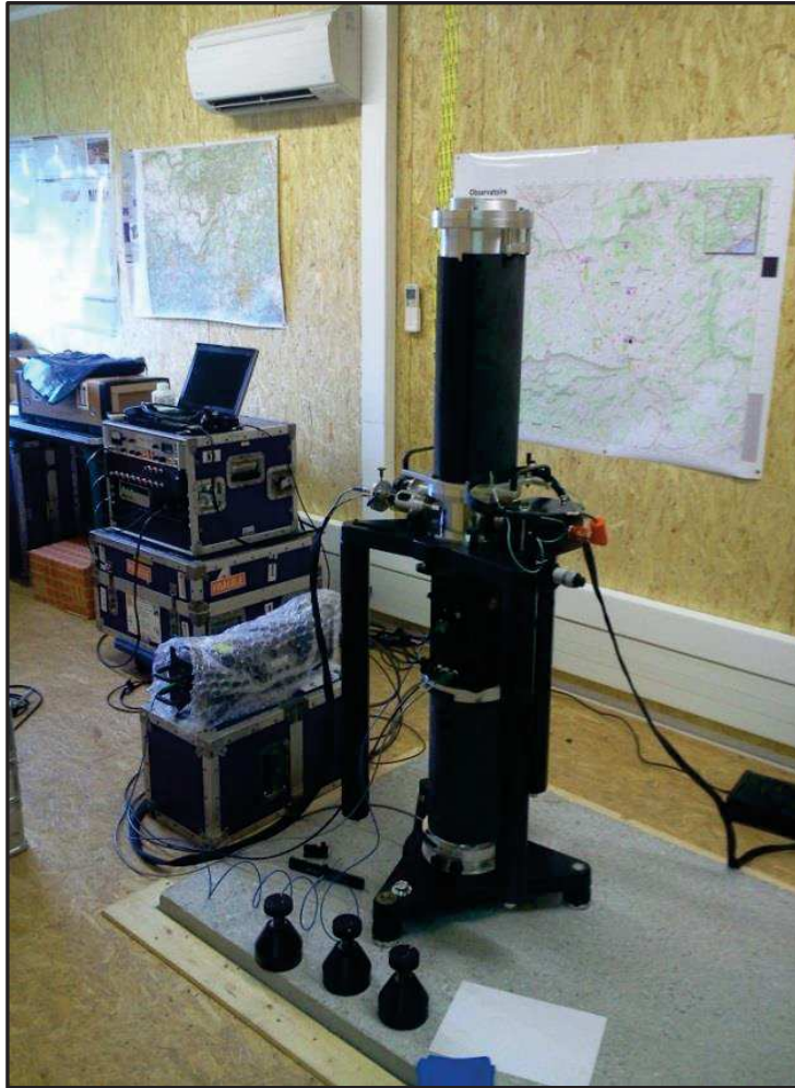
Figure 5.2 : FG5 mesurant dans l'observatoire du Larzac.
