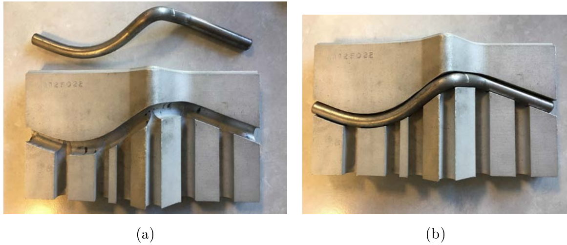
FIGURE 1.3 – Gabarit avec une pièce que l'on veut contrôler (a) et résultat du contrôle (b)
