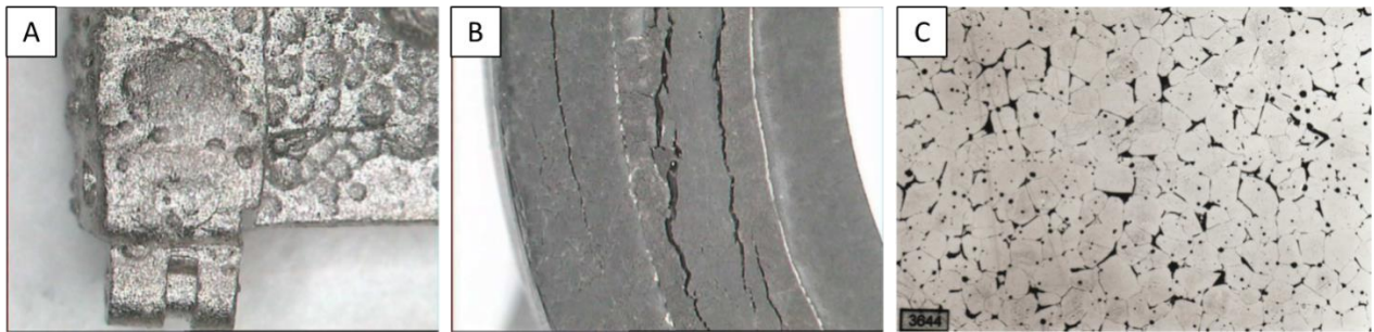
Figure I-8 Exemples de défauts rencontrés lors de l'étape de déliantage, A : composant en 316L déformé par la pression des gaz lors de l'évaporation du liant, la formation de cloques est liée à la ductilité du matériau, B : Composant en céramique fissuré par la pression des gaz et C : composant en 17-4PH avec un trop fort taux de carbone (>0,1%) dû à une pollution par les résidus carbonés après dégradation du liant. 45
