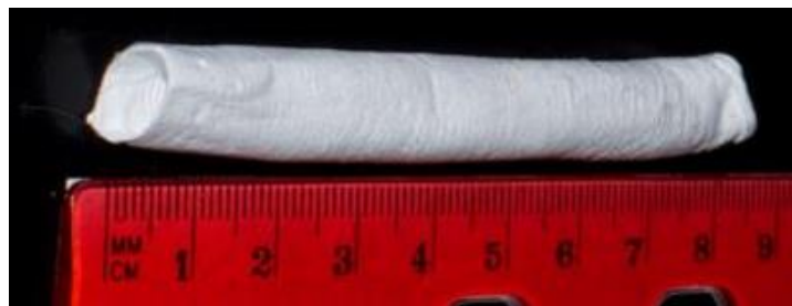
Figure 55. Échafaudage tubulaire de nanofibres
