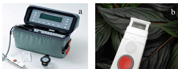
Figure 37 : Poromètre (a) et tête de mesure du poromètre (b) (source : Bouhoun Ali, 2014).
