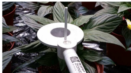
Figure 47 : Pyrromètre pour mesurer le rayonnement net (Source : Agrocampus Ouest, 2014).
