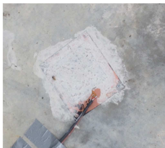
Figure 44 : Fluxmètre HFP01SC pour mesurer le flux de chaleur et de température du sol (Source : Agrocampus Ouest, 2014).
