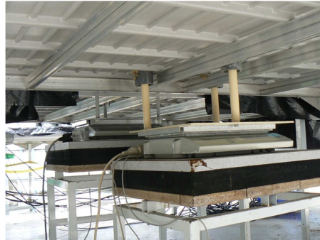
Figure 46 : Balances pour mesurer la transpiration des plantes en confort et en restriction hydrique (Source : Agrocampus Ouest, 2014).
