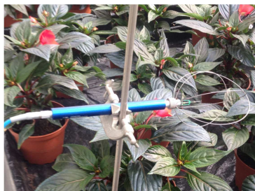
Figure 42 : Capteurs de vitesse de l'air boule chaude (Source : Agrocampus Ouest, 2014).
