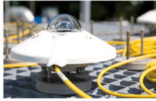
Figure 40 : Pyranomètre : capteur de rayonnement incident de courte longueur d'onde (source : http://www.kippzonen.fr/News/581/Principe-de-fonctionnement-d-un-pyranometre-a-thermopile ).
