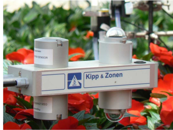
Figure 43 : Capteur de rayonnement (CNR1) courte et grande longueur d'onde (Source : Agrocampus Ouest, 2014).
