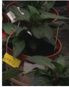
Figure 48 : Thermocouple fixé sur la feuille pour mesurer sa température (Source : Agrocampus Ouest, 2014).
