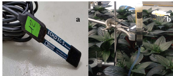
Figure 49 : Illustration d'une sonde ECH 2 O (a) et d'un tensiomètre (b) (Source : Agrocampus Ouest, 2014).
