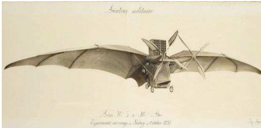
Figure 6 : L'avion III (l'Aquilon) créé par Clément Ader. L'engin possède une envergure de 16 mètres, il est testé au camp militaire de Satory en 1897, où il décolle péniblement du sol (crédit photo: Musée des arts et métiers).
