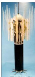
Le Sonar trempé FLASH, voir la figure ci-contre, a la particularité d'être embarqué sur des hélicoptères. Sa principale caractéristique, en dehors de la performance de sa mécanique (treuil rapide), est de pouvoir offrir l'ensemble des performances d'un Sonar embarqué dans un volume plus contraint que celui que l'on peut trouver sur une Torpille même légère.
