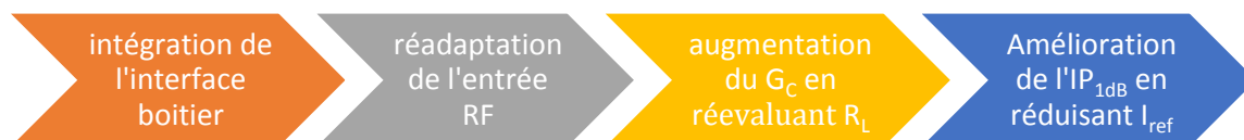
Figure 99 : étapes de réoptimisation du mélangeur en boîtier WLCSP
