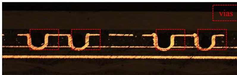
Figure 42 : coupe transversale du PCB au niveau des vias
