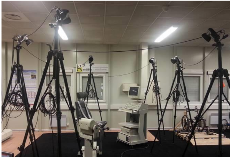
Figure 36 : Système de mesure optoélectronique placé autour du système de mesure dynamométrique (Biodex)
