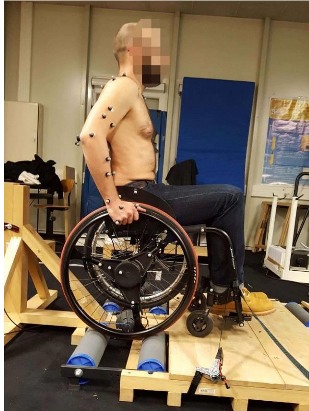
Figure 55 : Dispositif expérimental de mesure des efforts appliqués sur la main courante lors de la propulsion en FRM.
