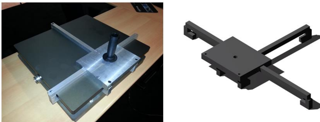
Figure 35 : Système de fixation de la poignée sur la plateforme de force. À gauche : photo du système réalisé et à droite : représentation 3D du système de fixation.
