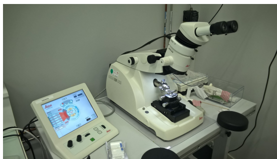
FIG. IV.5 – Ultramicrotome LEICA EM UC6 of IPANEMA, Saclay.
