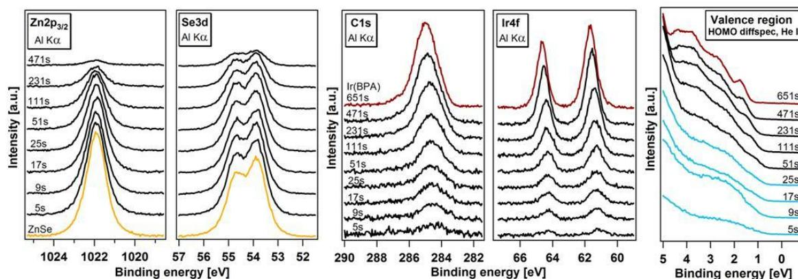
**Figure 11:** Zn2p<sub>3/2</sub> et Se3d spectres d'émission du substrat de ZnSe, ainsi que les C1s, Ir4f et des spectres d'émission de zone de valence de l'Ir(BPA) surcouche pendant le dépôt par étapes de Ir(BPA) sur ZnSe. Les Ir(BPA) des temps de dépôt sont indiqués.
