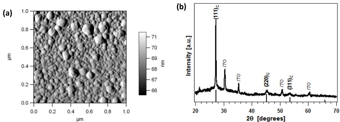
**Figure 5:** (a) Image AFM de la surface et (b) diagramme de XRD (avec des marques le long de la barre sur l'axe des x) pour l'essentiel d'un film de ZnSe déposée par évaporation thermique sur un substrat en verre d'ITO.
