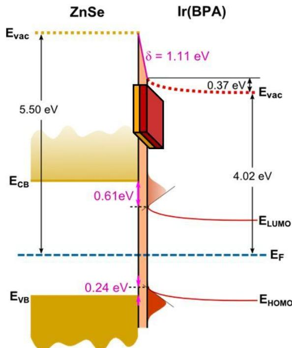
**Figure 8:** Interface diagramme de bande de la bicouche ZnSe/Ir(BPA), y compris un grand dipôle de l'interface de 1,11 eV et de la bande de flexion dans l'émetteur de 0,37 eV.
