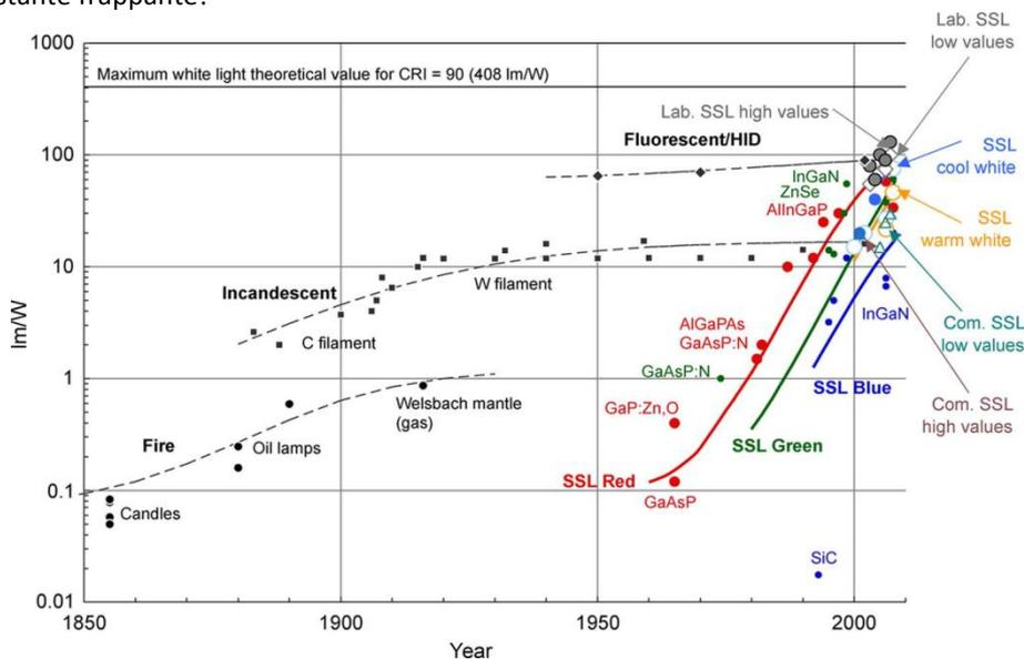
**Figure 2:** Efficacités lumineuses de technologies d'éclairage sélectionnés entre 1850 et 2006.<sup>3</sup>
