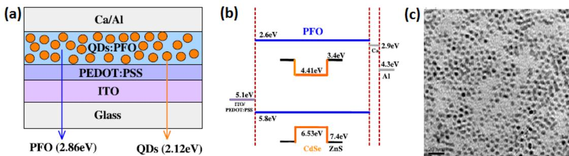
**Figure 3:** (a) Un schéma d'une structure de dispositif à couche unique qui montre les points quantiques de CdSe/ZnS noyés dans une couche de PFO sandwich entre ITO et Ca/Al électrodes. Les flèches indiquent les pics d'énergie EL des boîtes quantiques et PFO. (b) Energy niveau schéma du dispositif, où toutes les énergies sont indiquées par rapport au niveau de vide. (c) HR-TEM de 80% en poids QD intégré dans PFO.<sup>7</sup>
