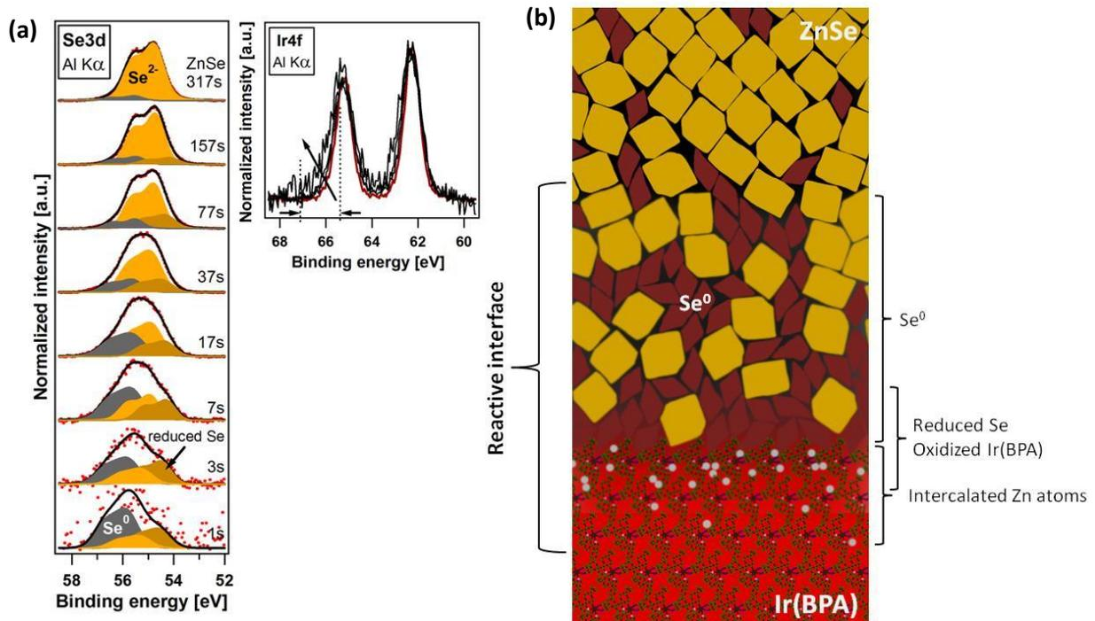
**Figure 14:** (a) Pic équipée Se3d photoémission spectres (bon ajustement est obtenu avec trois contributions qui sont affectés à élémentaire Se<sup>0</sup>, Se<sup>2-</sup> en ZnSe et un volet Se plus réduite). Spectres d'émission Ir4f révèlent clairement espèces énergie de liaison élevés qui sont prononcés près de l'interface. (b) Une représentation de l'Ir(BPA)/ZnSe bicouche, qui présente une interface de matériel très impur.
