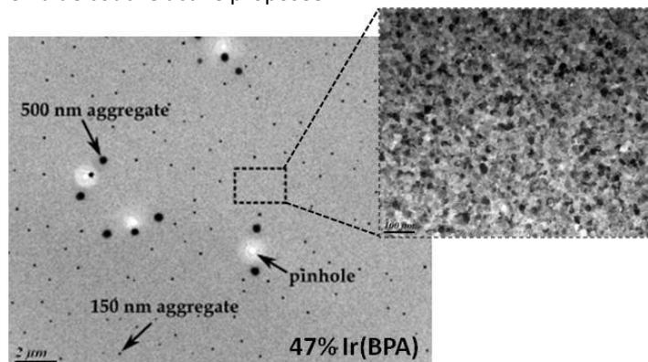
**Figure 9:** Images TEM d'une ZnSe+Ir(BPA) de composite avec un film de pourcentage en volume de 47 Ir(BPA). L'agrégation du colorant augmente avec la quantité accrue de concentration de colorant dans le film composite.
