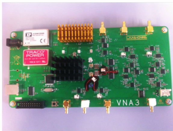
FIGURE III.8 – Photo de la carte électronique permettant l'actionnement et la détection du mouvement des résonateurs.
