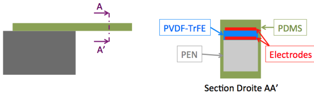
FIGURE II.3 – Vue schématique de profil et en coupe de la structures des leviers.
