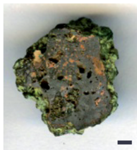
FIGURE 2.26 – Scorie ou résidu de bronze n° 317 découvert sur le site de Bibracte et datant du Ier siècle av. J.-C. Photographie de la section transversale de l'échantillon découvert par Béatrice Cauuet en 2005 et datant de ~80–50 av. J.C., polie au diamant jusqu'à 1/4 \mu\text{m} . Section préparée par L. Robbiola. Barre d'échelle : 2 mm
