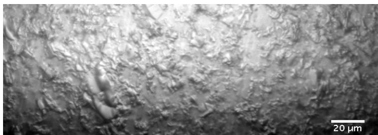
FIGURE 3.5 – Image de photoluminescence du standard SRM613 sous excitation à 275 nm. Image enregistrée sur le microscope Télémos avec l'objectif 40× et avec le filtre 535–607 nm pendant un temps d'intégration de 20 s.
