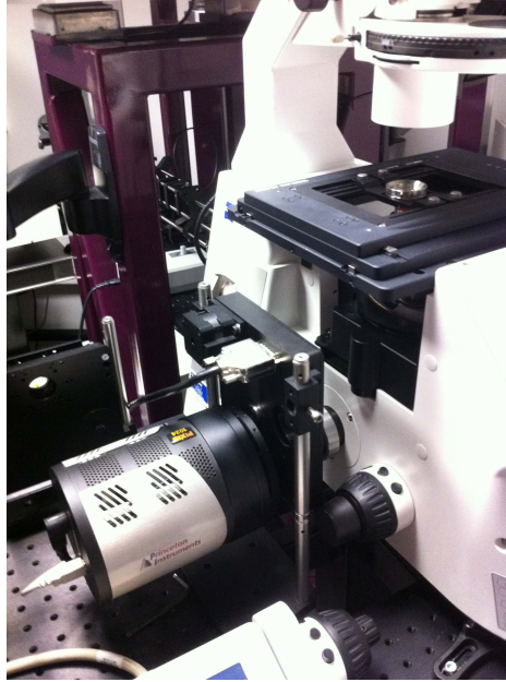
FIGURE 3.33 – Positionnement de la caméra PIXIS en sortie du microscope. La roue de filtres interférentiels empêche de positionner la caméra directement en sortie du microscope.
